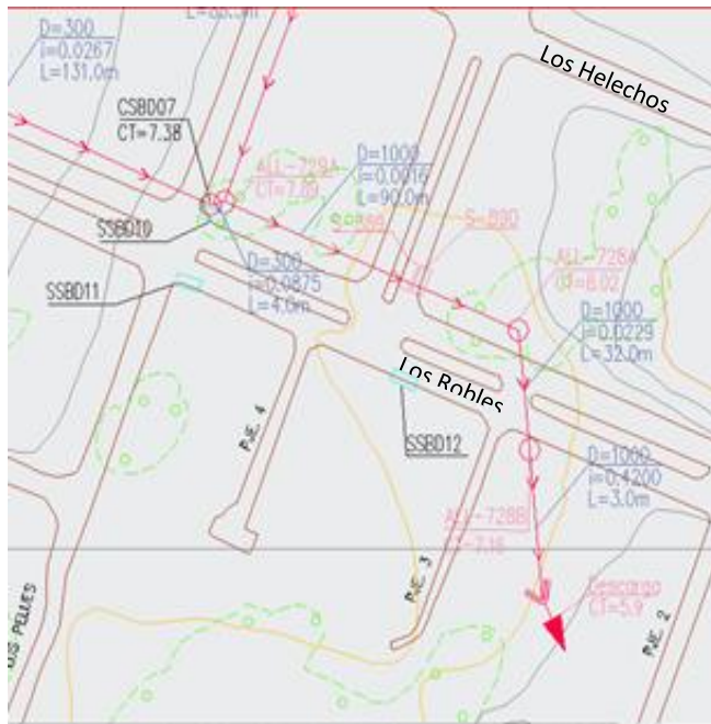
Fuente: Plan Maestro de Aguas Lluvias 2014 Imagen 17. Entubamiento descarga de aguas lluvias, Sector Isla Teja
